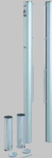
Ausführung rund Ø83 mm oder vierkant 80 x 80 mm. Aluminium Spezialprofil mit Innenverstärkung und Nut für die Befestigung der Netzhaltestange. Innenliegende Trapez-Spannmechanik mit Aluminiumschlüssel zum einfachen Spannen des Tennisnetzes. Steckbare Abdeckkappe aus Aluminiumguss mit Sicherungskette. Gesamtlänge der Pfosten 142 cm. Gewicht 10,5 kg. Bodenhülsen aus Alu, Einstecktiefe 350 mm komplett mit Alugussdeckel. GS geprüft nach DIN EN 1510, in verschiedenen Farben lieferbar.
