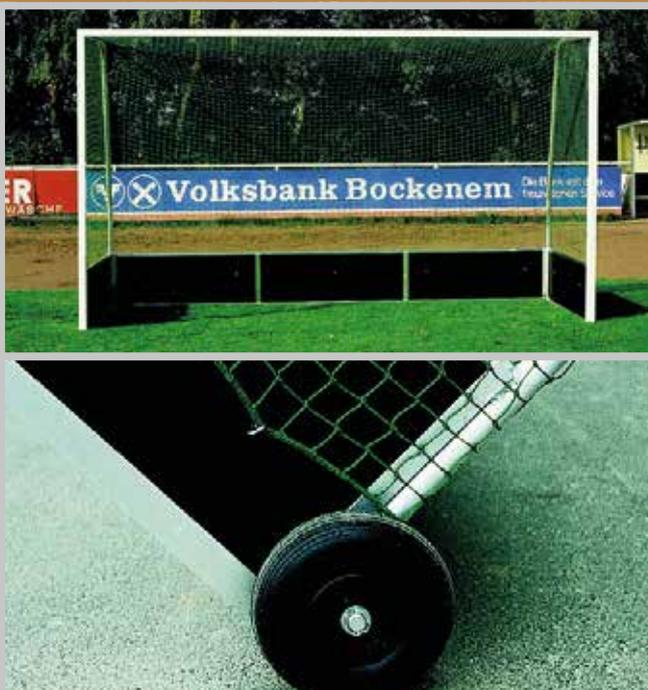
JOBASPORT®-Feldhockeytore 3,66 x 2,14 m nach internationaler Vorschrift. Eine Konstruktion aus Alu-Profil 75 x 50 mm. Latte/ Pfosten weiß einbrennlackiert, superstabil mit Banden aus mehrfach verleimten Sperrholz, wasserfest. Höhe der Banden 460 mm.
