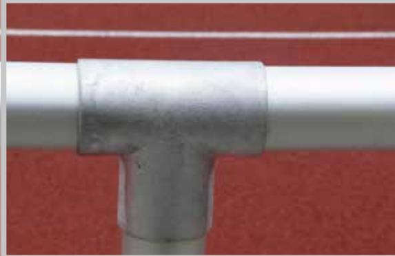
Alu-Barriere aus Rundrohr  $\text{Ø}60 \times 2,5$  mm, technisch eloxiert, mattsilber. Die Höhe der Standrohre oberhalb vom Boden beträgt 1,10 m und das Feldrastermaß der Standrohre ist 2,50 m. Lieferung incl. Alu-Guß-T-Formteile und Befestigungsmaterial.
