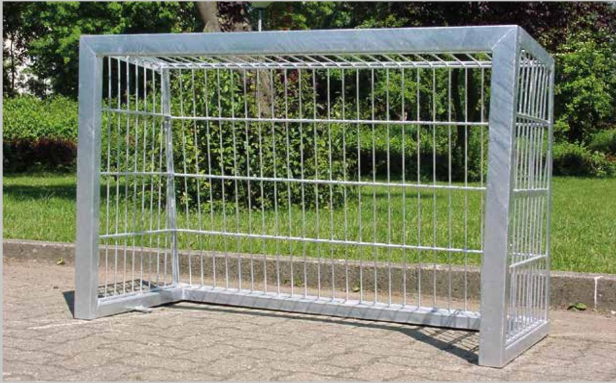
Dieses Streethockeytor ist eine komplett verschweißte Konstruktion aus Stahl feuerverzinkt. Es besteht aus Profil 60 x 40mm, die Hinterkonstruktion ist eine Herkules Gittermatte. Am Tor sind 2 Laschen angeschweißt um diese am Boden zu verankern. In der Lieferung enthalten ist ein Befestigungssatz zum Einbetonieren. Das Tor ist ausserdem TÜV geprüft nach DIN EN 15312.
