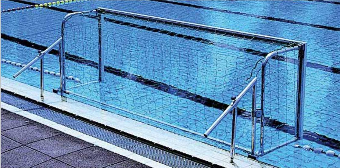
Stabile Latte / Pfosten Konstruktion aus Profil 75 x 40 mm, weiß einbrennlackiert, die Beckenrandbefestigung ist aus Alu-Rohr Ø40 mm gefertigt und alu natur. Passende Beckenrandbefestigungssatz für Bodenhülsen Ø42 mm. Lieferung komplett inkl. Netzhaken, jedoch ohne Bodenhülsen und Netz.
