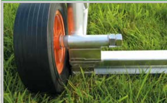
Für die Radaufnahme wird das Bodenrahmenprofil hochkant angeschweißt.
