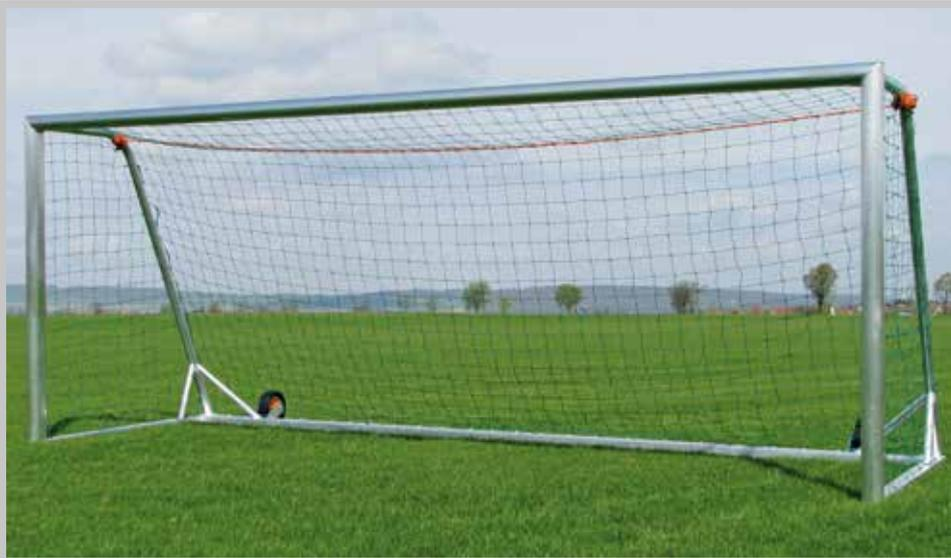
Latte/Pfosten aus Ovalprofil 120 x 100 mm, Bodenrahmen aus Profil 80 x 80 mm, im hinteren Bereich doppelt, zum Befüllen vor Ort mit trockenem Quarzsand durch 8 große Öffnungen, Netzbügel aus Rundrohr 60 x 3 mm. Lieferung inkl. Netzhaken und 2 Stück angeschweißten Rädern. Es ist im befüllten Zustand keine weitere mechanische Befestigung nötig. Diese Tore sind nach EN 748 Type 4.
