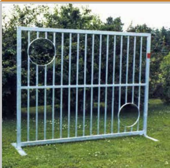
Bolz-Torwand aus Stahl. Größe 2,50 x 2,00 m. Rahmen aus Rechteckrohr 60 x 40 mm. Innengeflecht aus Vollstahl. Befestigung durch Einbetonierstützen oder mit Flanschplatte. Ausführung vollverzinkt. TÜV geprüft nach DIN EN 15312
