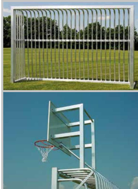
Ideal für Spiel-, Pausen- und Freizeitplätze sind diese Bolzplatztore 3,00 x 2,00 m freistehend. Eine komplett verschweißte Alu-Konstruktion aus dickwandigem Profil 80 x 80 mm oder 100 x 120 mm. Oberfläche Alu-natur. Hinterkonstruktion aus Rundrohr 35 x 3 mm, je 6 Platten am Bodenholm angeschweißt für Befestigung mit Bodenanker (im Lieferumfang enthalten). Alternativ mit Basketball-Übungsanlage verstärkt, einschl. Brett 1,20 x 0,90 m, Korb und Netz.
