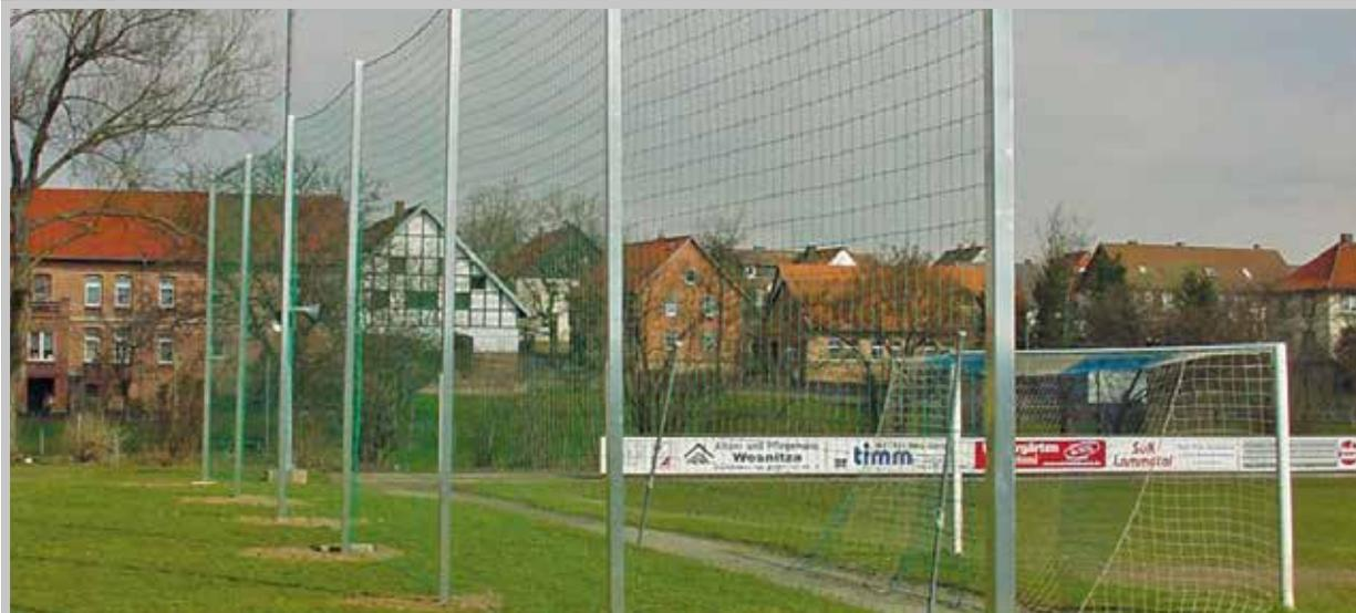
Eine stabile Konstruktion aus dem bewährten Profil 80 x 80 mm oder 120 x 100 mm. Die Standpfosten werden in einem Abstand von 5,00 m gesetzt. Die Pfosten aus Ovalprofil können zusätzlich mit einem Verstärkungsprofil geliefert. Lieferung inkl. Bodenhülse, Netzhaken, Ringöse und Top-Kappe.
