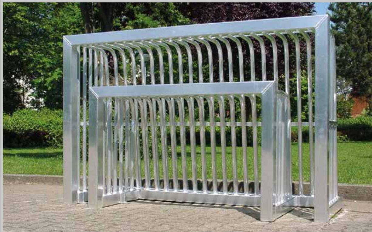
Eine vollverschweißte superstabile Konstruktion aus Alu-Profil 80 x 80 mm, Hinterkonstruktion aus Rundrohr Ø 30 mm. Die Rohre sind gebogen, damit das Tor oben komplett geschlossen ist. Seitlich 2 angeschweißte Laschen für die Bodenbefestigung, Bodenanker zum Einbetonieren sind im Lieferumfang enthalten.
